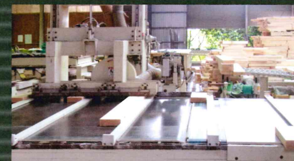
精密なコンピュータによって寸分の狂いなくプレカット。合理性、工期の短縮により、コストを安く抑えました。
